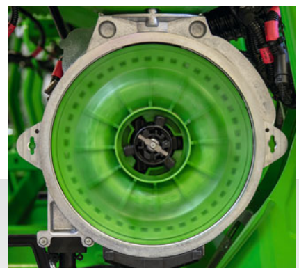
Disque de sélection en fonctionnement (sans couvercle)
