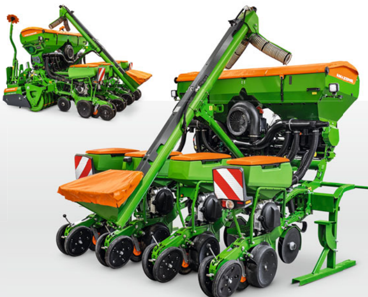
Precea 3000-ACC compact avec cultivateur rotatif Cultimix KG 3001 Special
